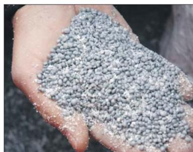
EPS (expandiertes Polystyrol) wird als Perlen mit einem Feinanteil in die Luftschicht des Mauerwerks geblasen.
